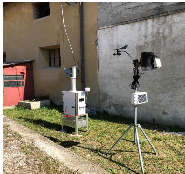
Figure 4.1 - Allestimento Laboratorio Mobile – Analizzatori e Campionatori Sequenziali
