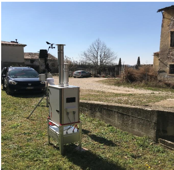
Figure 4.1 - Allestimento Laboratorio Mobile – Analizzatori e Campionatori Sequenziali
