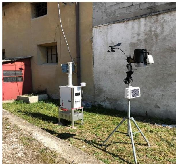
**Figure 4.1 - Allestimento Laboratorio Mobile – Analizzatori e Campionatori Sequenziali**
