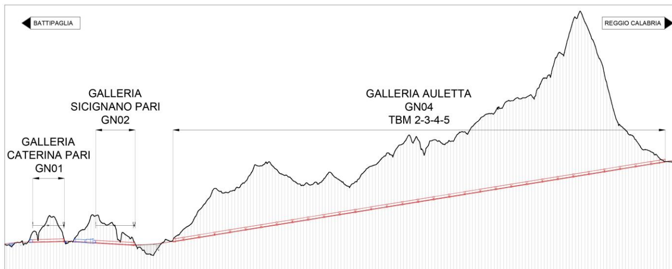
Figura 2 Profilo altimetrico delle gallerie naturali di linea (b.p.)
