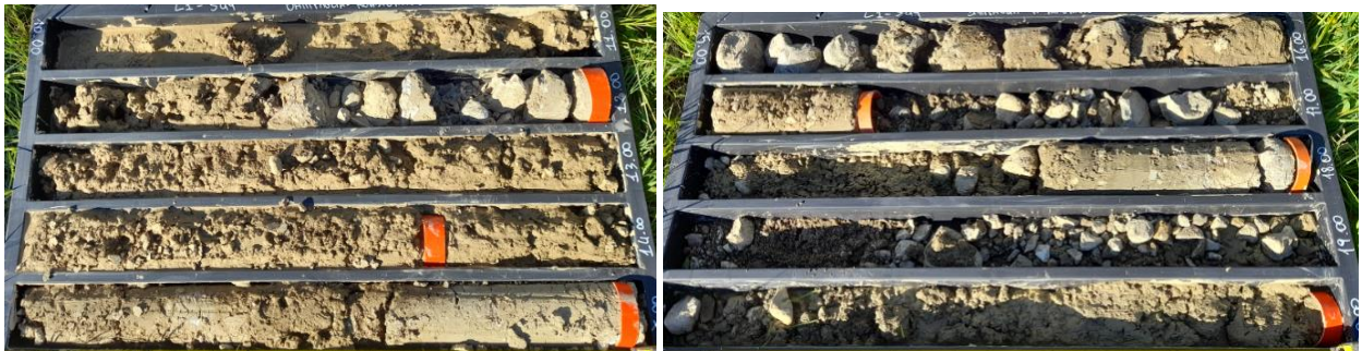
Figura 50 RGC nel foro di sondaggio S49 tra 10 e 20 m da p.c.
