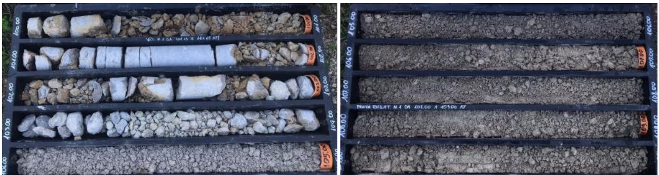
Figura 66 Cavità carsica riempita di materiale alluvionale (L1B-S45 tra 100 e 110 m da p.c.)
