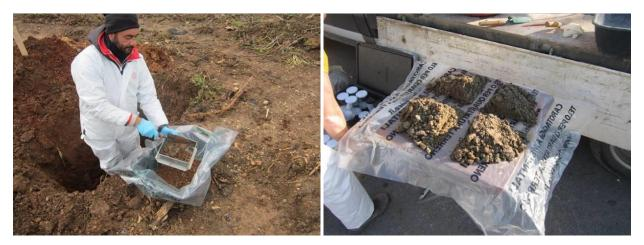
Figura 7-2 Fasi di setacciatura, omogeneizzazione e quartatura del campione su fogli di polietilene monouso
