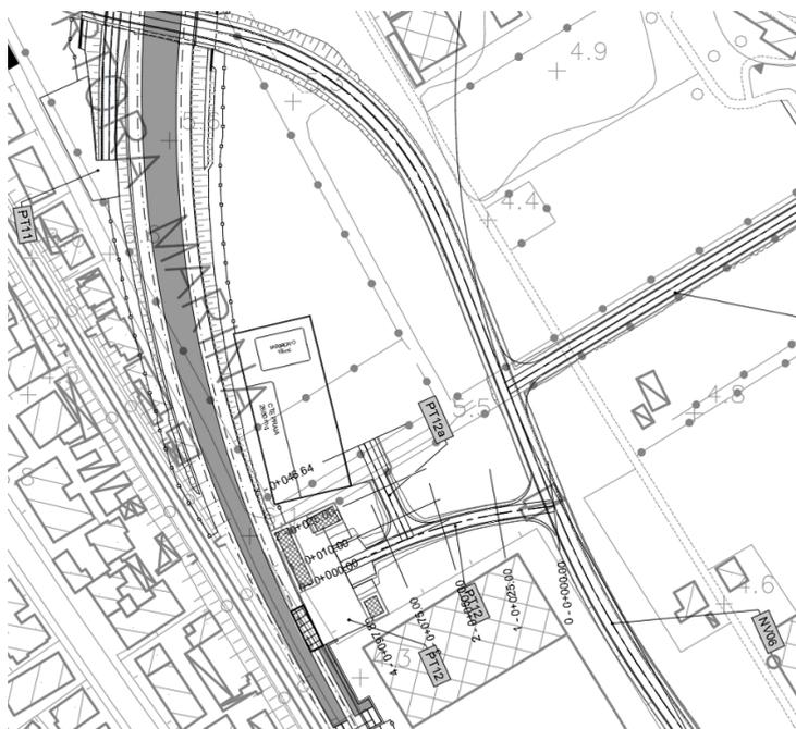
La piattaforma è quella prevista per gli accessi ai piazzali con corsie di 2,75 m e banchine laterali da 0,50 m per una larghezza complessiva di 6,50 m, incrementata in corrispondenza degli allargamenti per iscrizione in curva.
