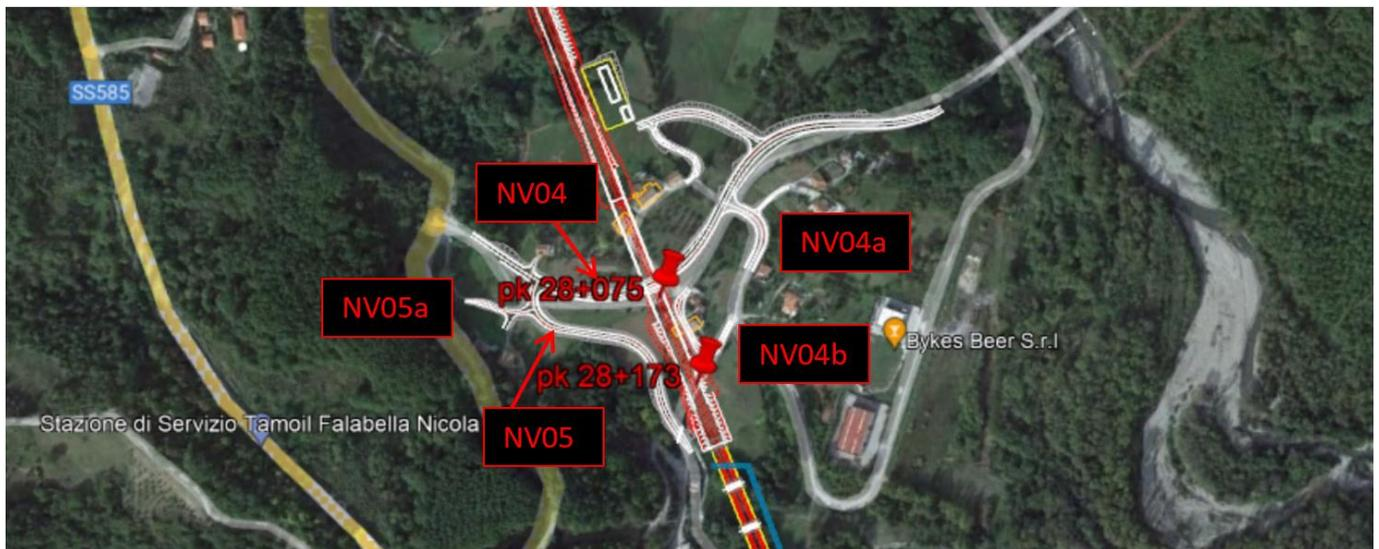
Questa configurazione di progetto della NV05 permette di garantire la continuità della viabilità interferita, ripristinando gli accessi ad Est della ferrovia grazie alla NV04b di progetto. Il ramo NV05a ricollega gli accessi presenti sulla viabilità esistente connettendoli alla NV05 di progetto.
