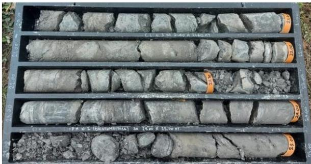
**L 1B-S 52:** Cassetta n. 5 da 20.0 a 25.0 m: Argillite da consistente a molto consistente con ciottoli millimetrici; a tratti si trovano livelli cm di arenaria quarzosa.
