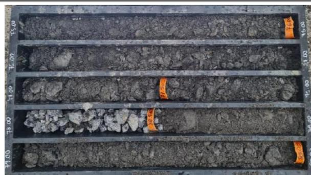
**L1B-S60:** Cassetta n. 16 da 75.0 a 80.0 m: Dolomia di colore grigio-nerastra fortemente tettonizzata e alterata. Al carotaggio si sgretola, dando origine a sabbia, con a tratti livelli litoidi centimetrici costituite da breccie di dolomia.
