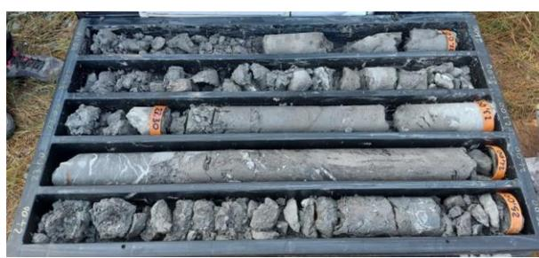
**L 1B-S 42:** Cassetta n. 5 da 20.0 a 25.0 m: alternanza di argillite debolmente marnosa e arenite quarzosa
