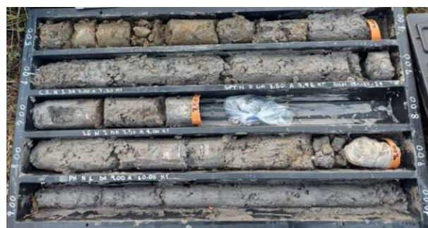
**L 1B-S 54:** Cassetta n. 2 da 5.0 a 10.0 m: Argilla limosa colore bruno tendente al grigio, da consistente a molto consistente, con inclusi millimetrici da subarrotondati ad arrotondati, grigiastri.
