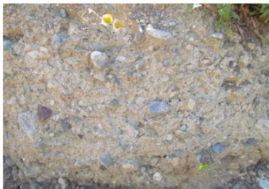
**L1C\_AV\_08:** Particolare delle ghiaie poligeniche ed eterometriche cementate - **PADb**
