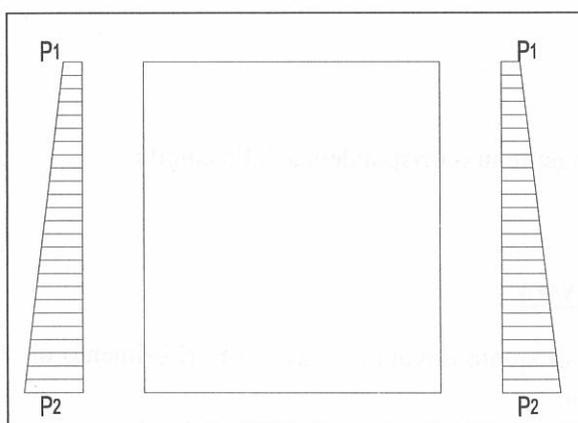
**Figura 4 - Diagrammi delle spinte applicate ai piedritti**
