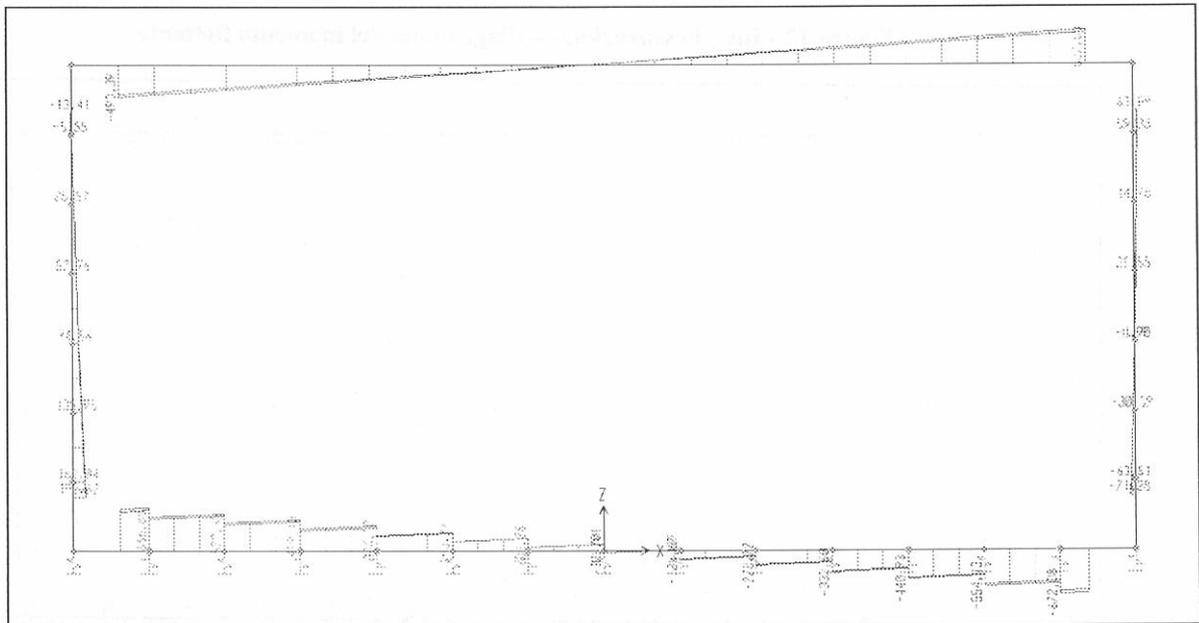
**Figura 11 - Inv\_Sisma – Diagramma del taglio**
