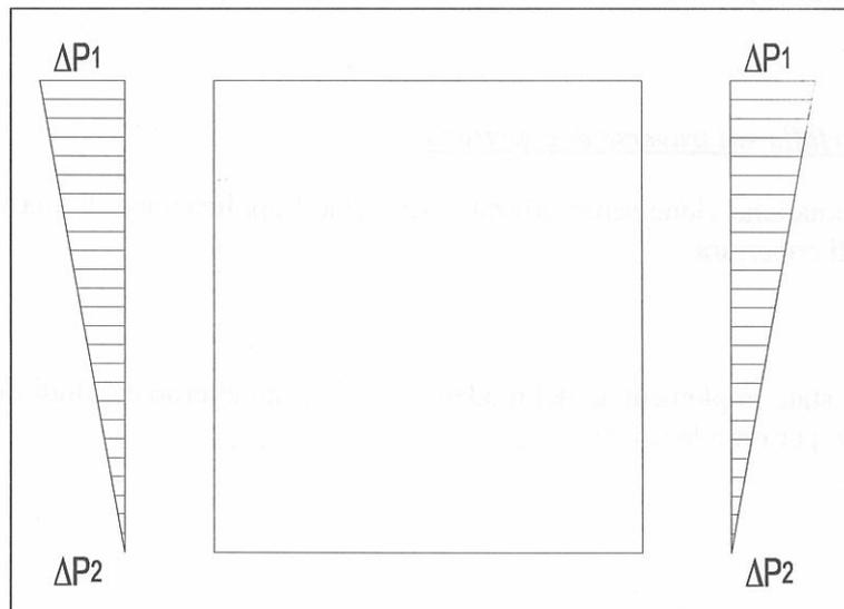
**Figura 5 - Diagrammi delle sovraspinte sismiche applicate ai piedritti**
