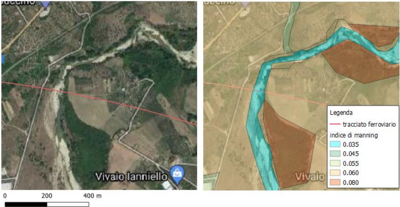
Figura 11 – Modello idraulico fiume Bianco: mappa dell'indice di Manning.
