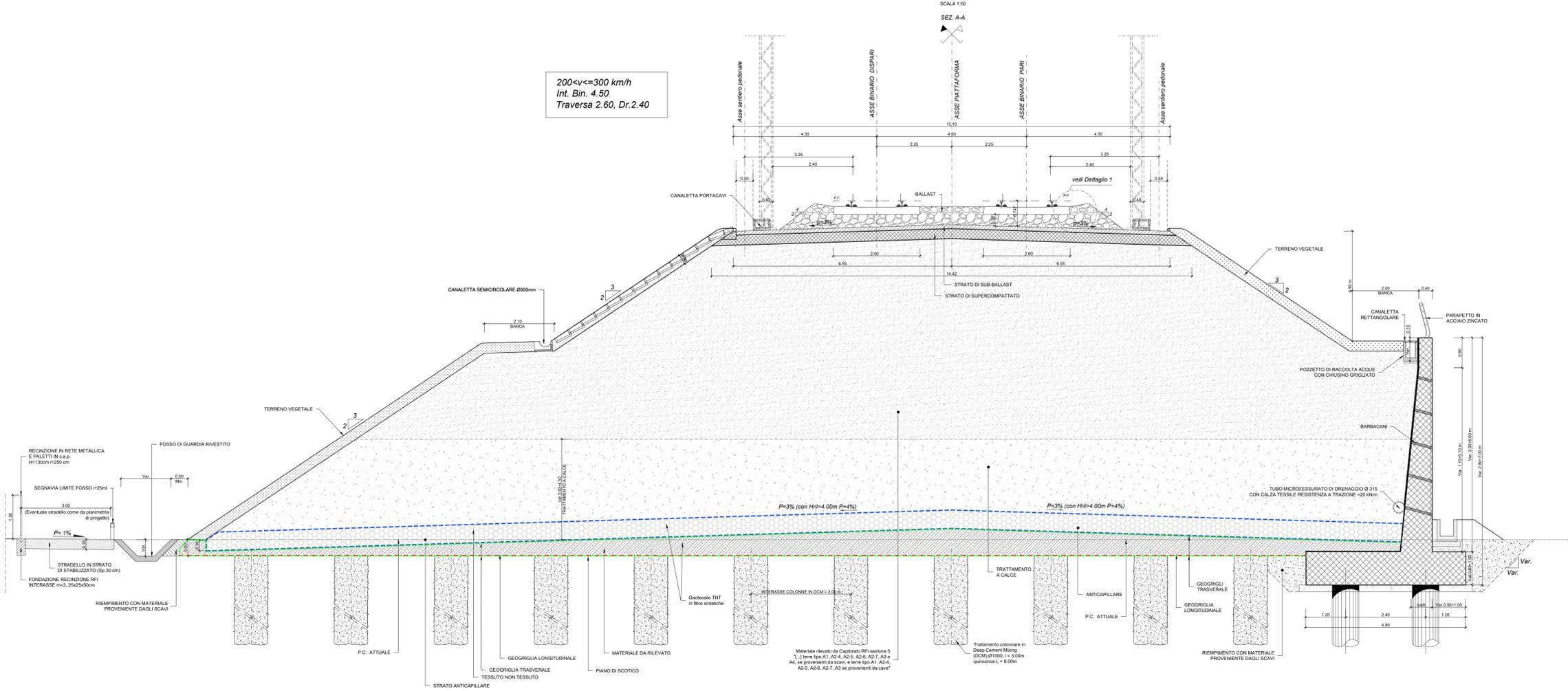
Pianta per sezione tipo con trattamento e muro di sottoscarpa (TIPO SD1)
