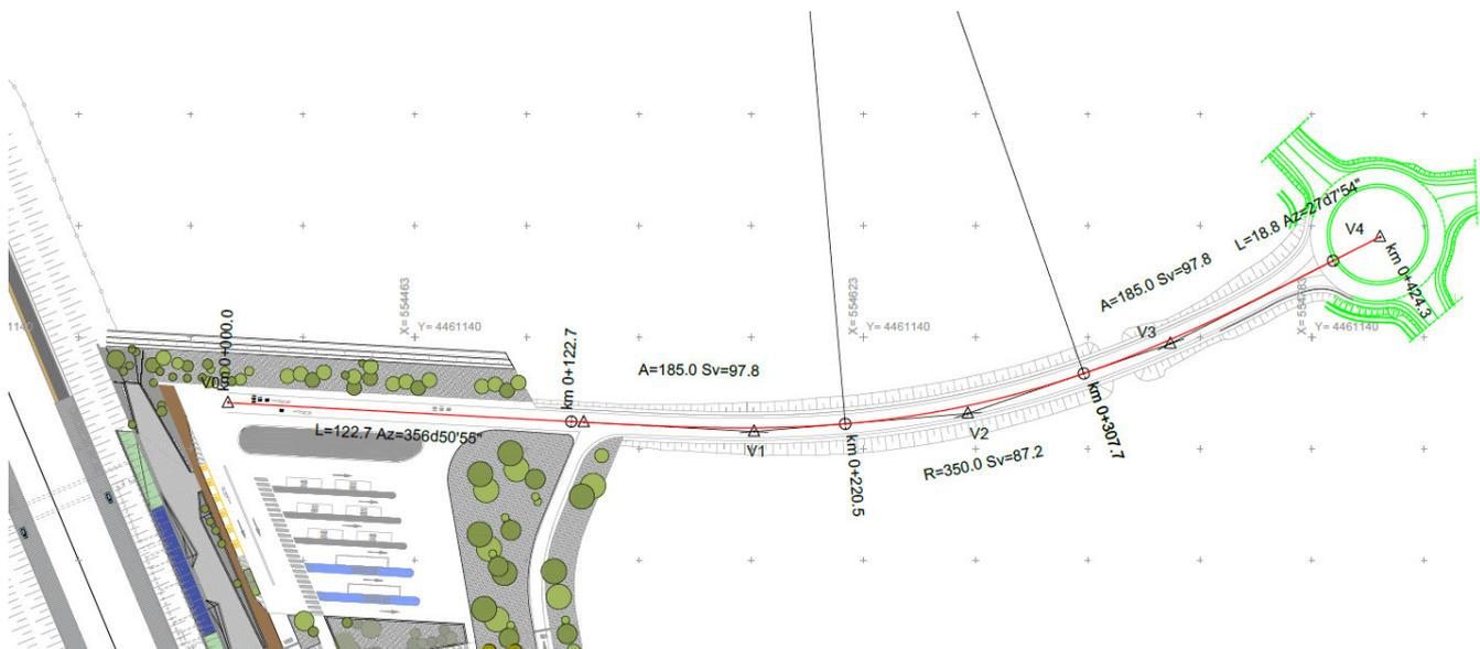
Altimetricamente la NV51 partendo dalla stazione verso la rotonda ANAS prevede la livelletta iniziale compatibile sia per quota che per pendenza con il Layout di stazione per poi alzarsi tramite un raccordo altimetrico di raggio pari a 1700 m e livelletta con pendenza pari al 2.67% dal quale parte il raccordo convesso di raggio pari a 2560 m di scavalco della nuova opera idraulica necessaria per garantire il superamento dell'interferenza idraulica.
