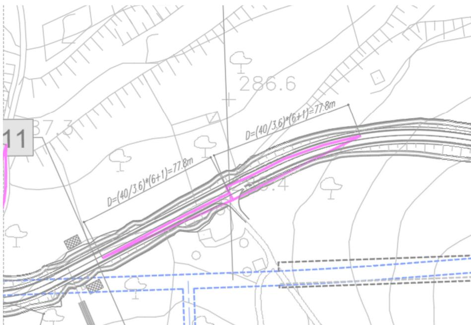
Di seguito i triangoli tra la PT12 e gli accessi PT12-A, PT12-B per i quali è stato previsto un allargamento all'intersezione per contenere i triangoli di visibilità.
