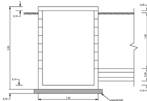
SCHEMA DI ASSEMBLAGGIO ELEMENTI PREFABBRICATI
