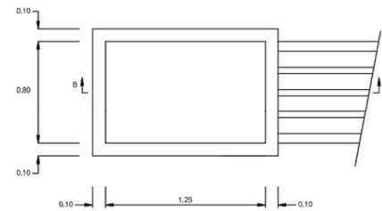
POZZETTO AFFIORANTE DI INTERCONNESSIONE REALIZZATO IN C.A.V. PREFABBRICATO E COSTRUITO DA ELEMENTI COMPONIBILI DI DIMENSIONI UTILI INTERNE mt. 1.25 x 0.80 x 1.80 CON CHIUSINO IN GHISA NORMALIZZATO (FORNITURA TELECOM)
