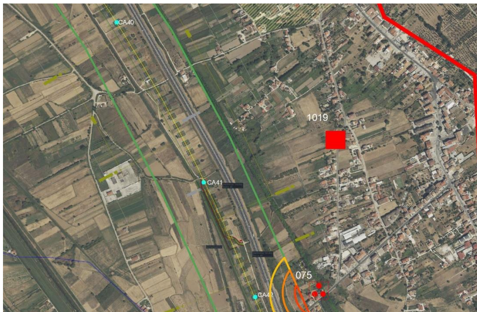
Figura 43 - Ubicazione dei carotaggi da CA40 a CA42
