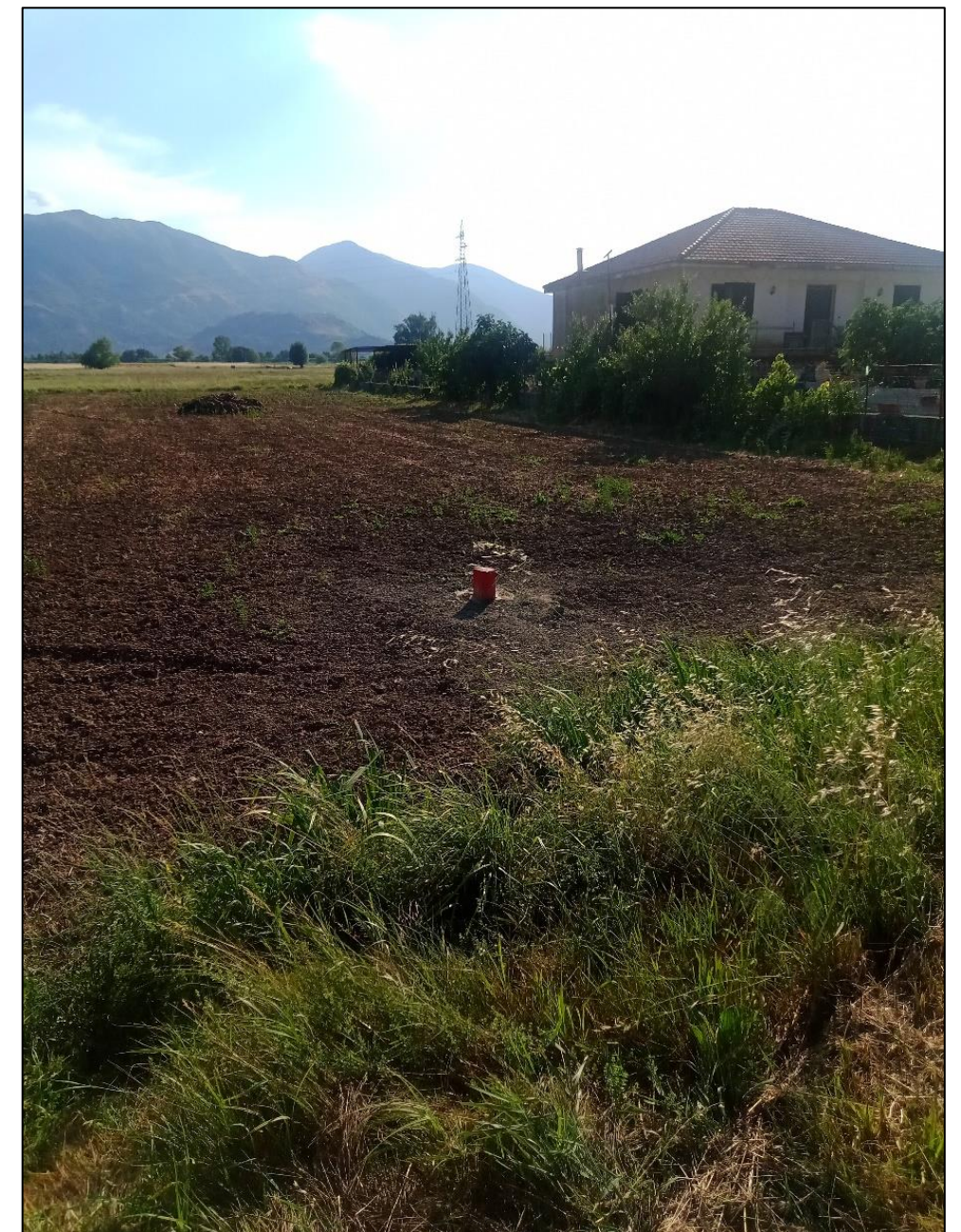
Foro di sondaggio L1B-S22 allestito per la prova Down Hole
