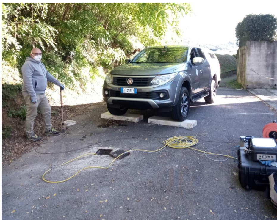
Figura 2.1.2.1: configurazione standard per le indagini Down Hole
