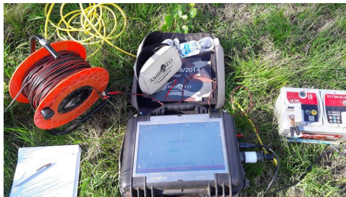
Figura 2.1.2.2: Sismografo digitale a 24 bit.
