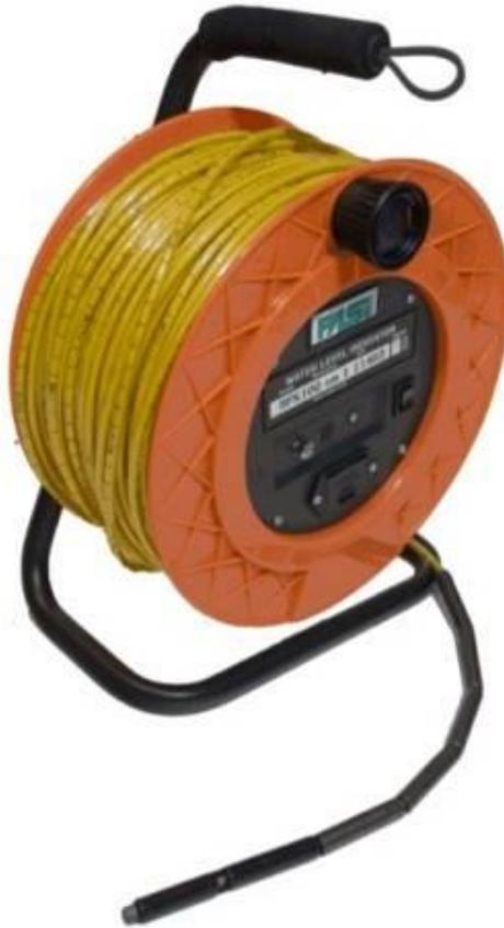
Figura 5. Dati tecnici freatimetro BFK
