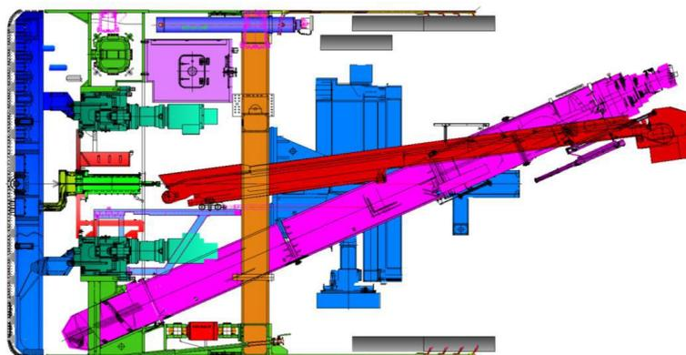
**Figura 76 TBM "convertibile" in configurazione EPB**
