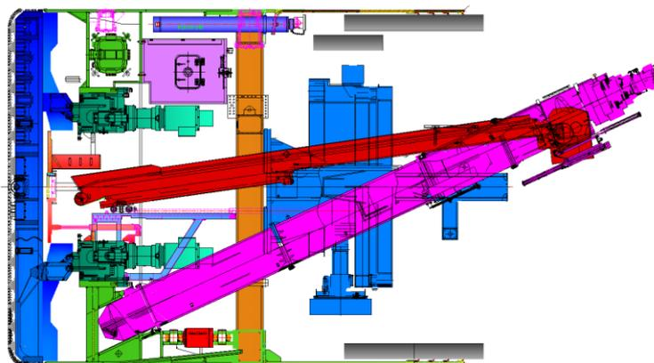
**Figura 77 TBM “convertibile” in configurazione da roccia**
