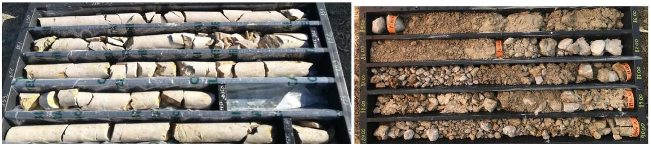
**Figura 23 CRQ nei fori di sondaggio L1B-S03 tra 150 e 155 m e L1B-S45 tra 85 e 90 m da p.c**
