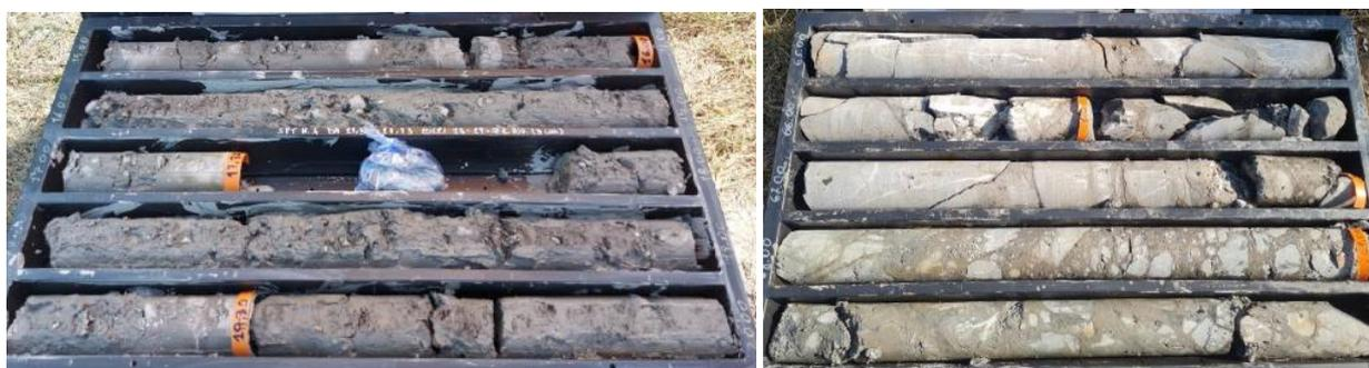
Figura 13 ABD nel foro di sondaggio S42 tra 15 e 20 m e nel foro di sondaggio S43 tra 65 e 70 m da p.c.
