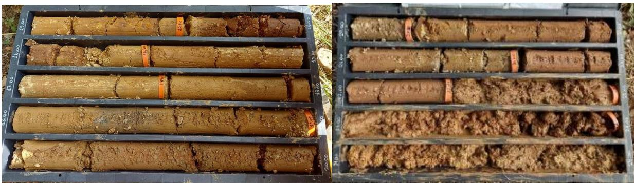
**Figura 73 g3 nel foro di sondaggio L1B-S64 tra 15 e 25 m da p.c.**
