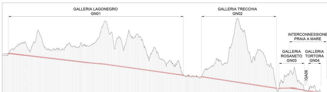
**Figura 2 Profilo altimetrico delle gallerie naturali (b.p.)**
