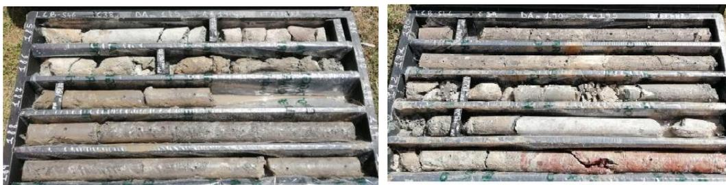
Figura 41 STSb nel foro di sondaggio L1B-S46 tra 185 e 195m da p.c
