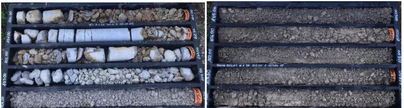
**Figura 24 Cavità carsica riempita di materiale alluvionale (L1B-S45 tra 100 e 110 m da p.c.)**
