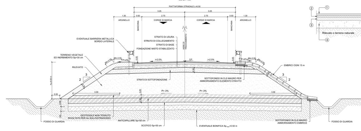
DETTAGLIO PAVIMENTAZIONE STRADALE TIPO 2
