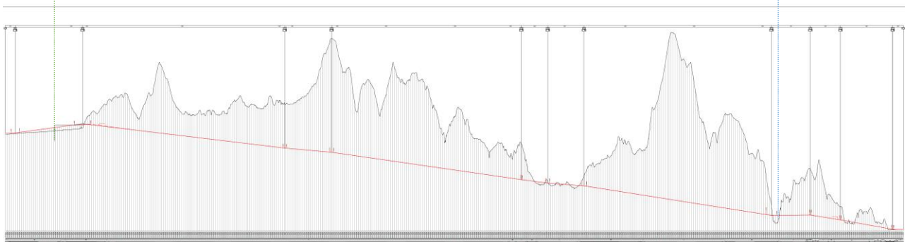
Figura 9 Profilo plano-altimetrico dell'alternativa di tracciato A
