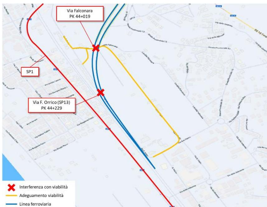
Figura 8 – Interferenze con le viabilità attuali e della viabilità di progetto (arancione) nell'Ambito 3
