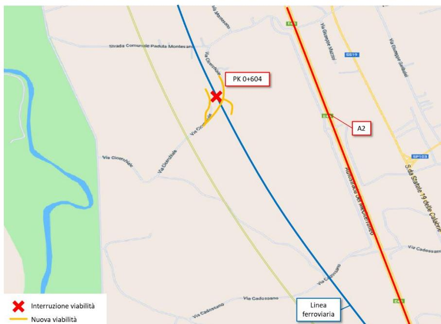
Figura 4 – Rappresentazione schematica dell'interruzione della viabilità attuale e della nuova viabilità di progetto (arancione) nell'Ambito 1
