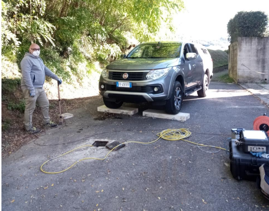
Figura 3.2.2.1: configurazione standard per le indagini Down Hole
