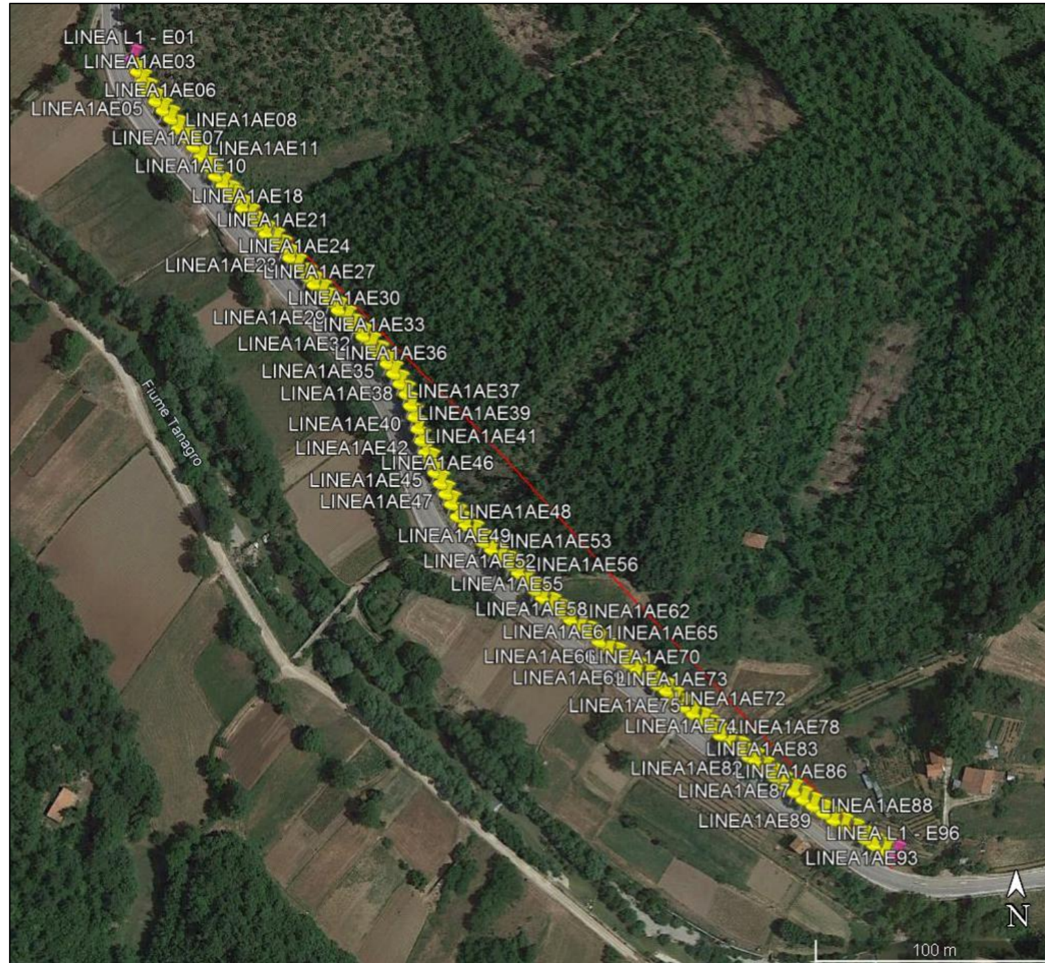
Ubicazione dell'indagine ERT L1 con distribuzione degli elettrodi di misura
