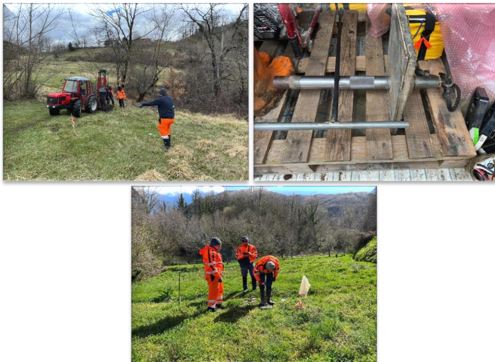
Figura 20. Sistemi energizzanti, Weight dropper e fucile sismico.
