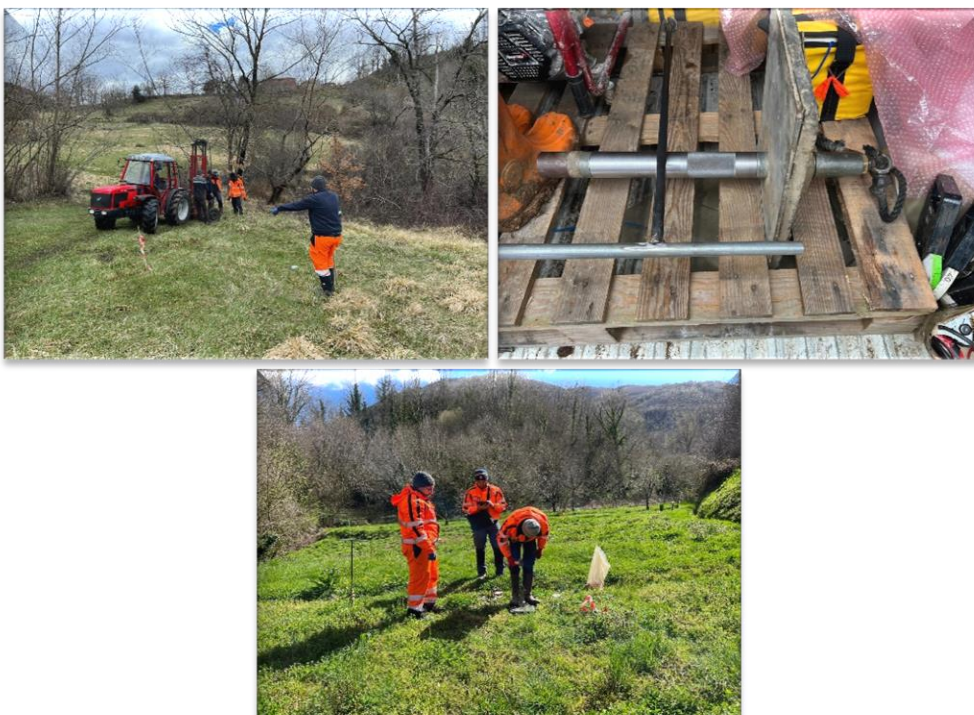
Figura 18. Sistemi energizzanti, Weight dropper e fucile sismico.
