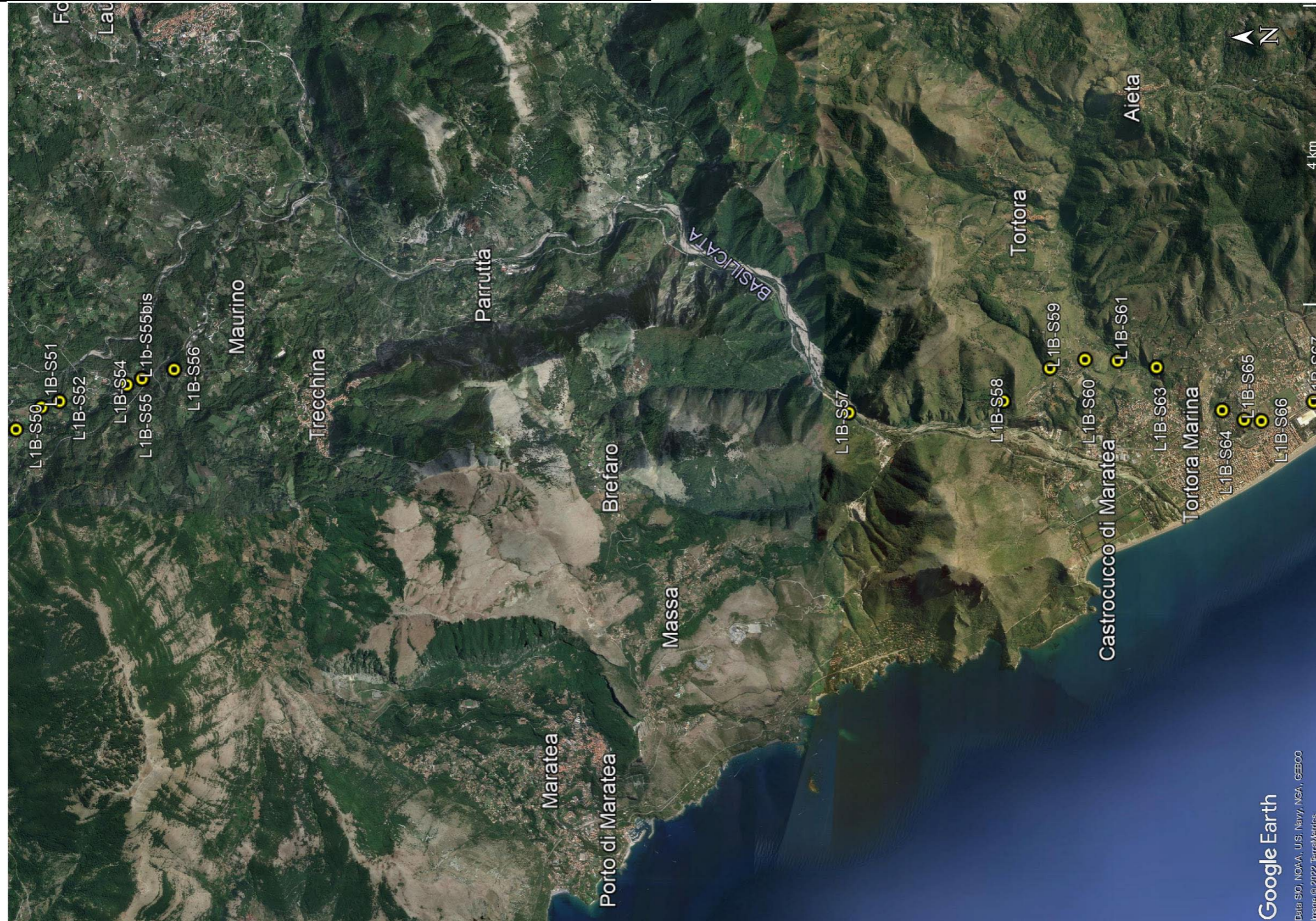
Figura 3. Planimetria su foto da satellite con ubicazione degli strumenti monitorati tav. 3 di 3 (da Google Earth – scala grafica). In giallo i piezometri e in arancio gli inclinometri
