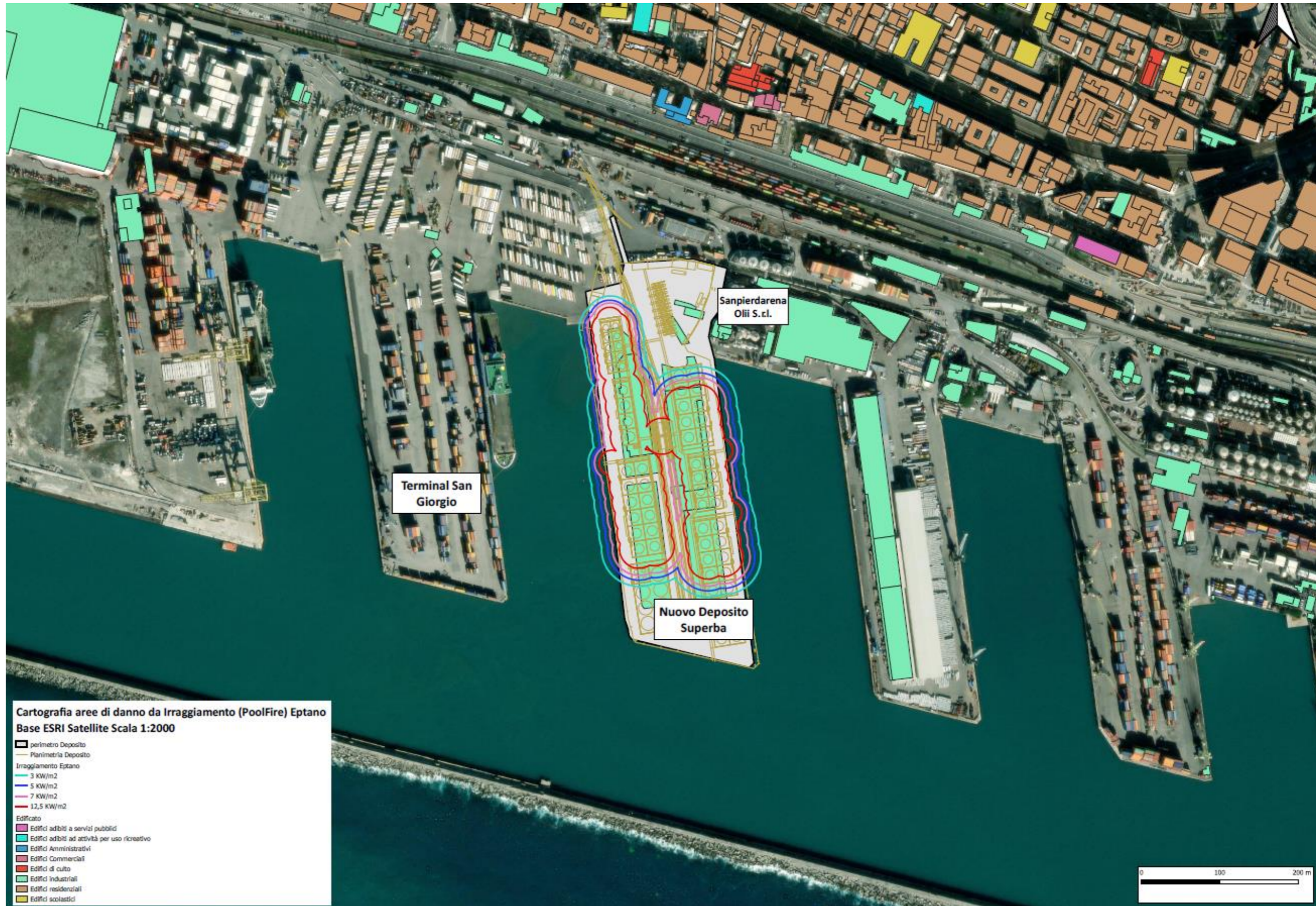
Figura 122 - Aree di danno da Irraggiamento (PoolFire) Eptano [Fonte: Rapporto preliminare di Sicurezza].
