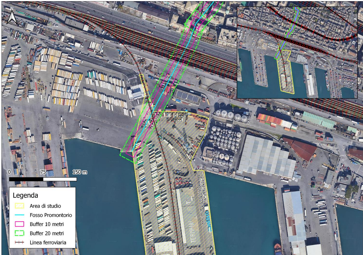
Figura 42 – Localizzazione di Fosso Promontorio rispetto all’ipotetica linea ferroviaria a servizio di Ponte Somalia
