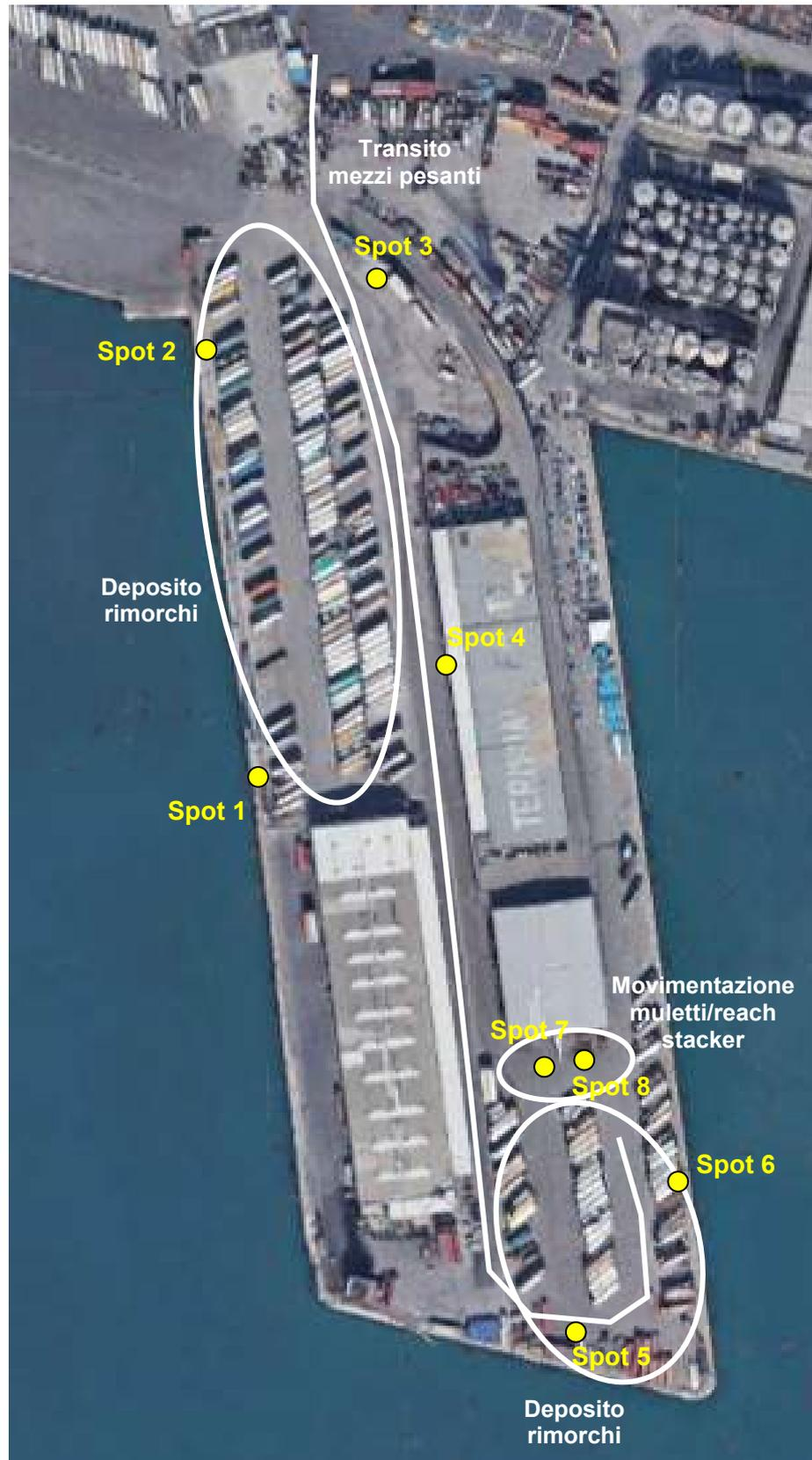
Figura 5 – Foto aerea del Ponte Somalia con individuazione delle postazioni di rilievo fonometrico
