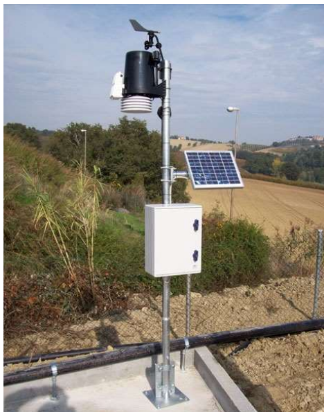
Figura 39 - Esempio di stazione meteorologica
