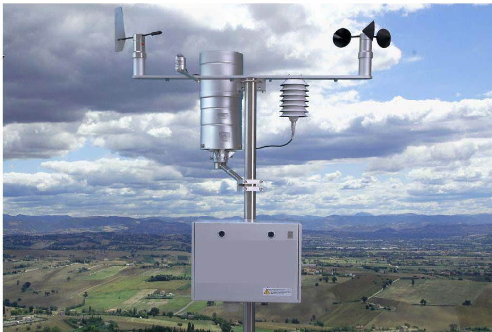
Figura 5 - Esempio di stazione meteorologica multi-parametrica
