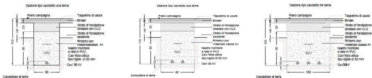
Figura 15 - Tipici di posa sezione cavidotti MT su strada asfaltata
