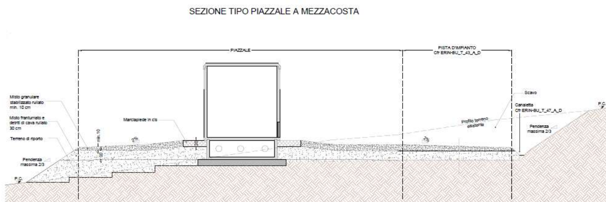
Figura 9 Sezione tipo piazzale a mezzacosta
