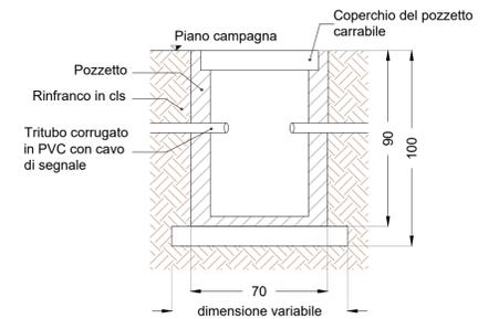
SEZIONE TIPO CAVIDOTTO SU TERRENO
