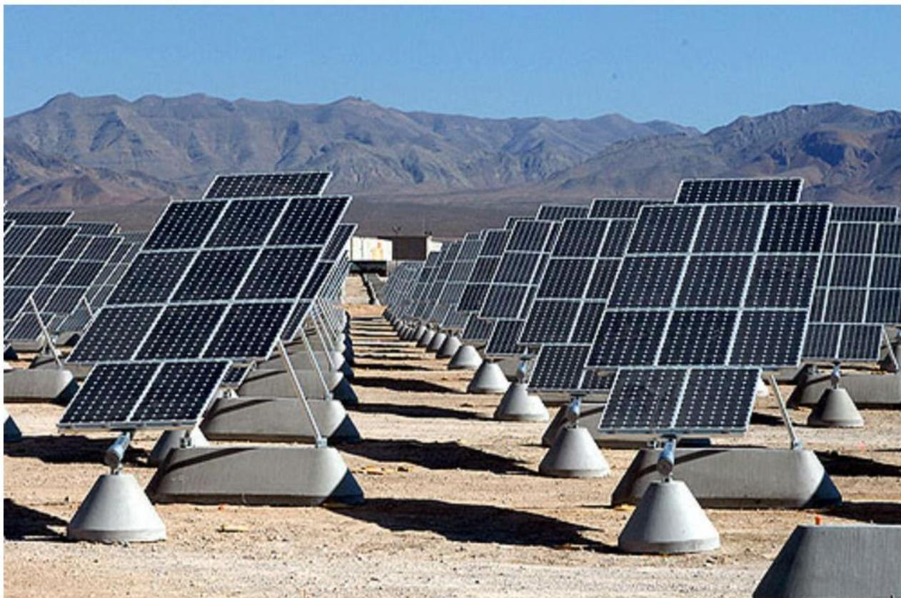
*Figura 58 Esempio d'impianto monoassiale (inseguimento ad asse polare)*
