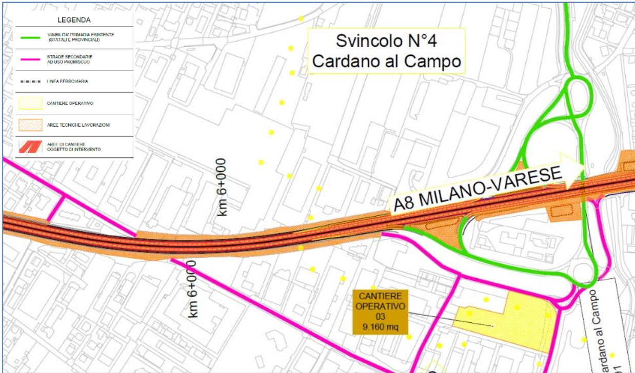
Figura 5.8: dettaglio aree tecniche di lavorazione, sia su SS336 che in adiacenza per opere di allargamento
