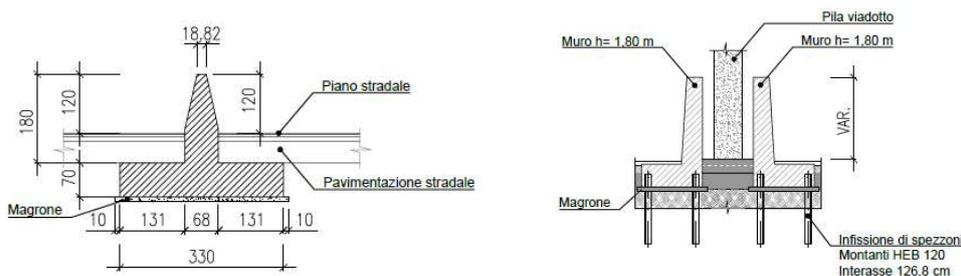
Figura 7.6: Opere minori a protezione dei punti singolari
