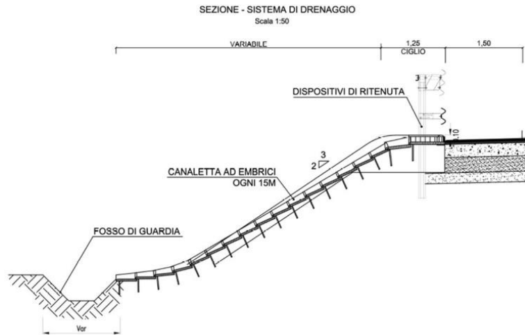
Figura 5-4 Tratto in rettilineo - drenaggio con embrici
