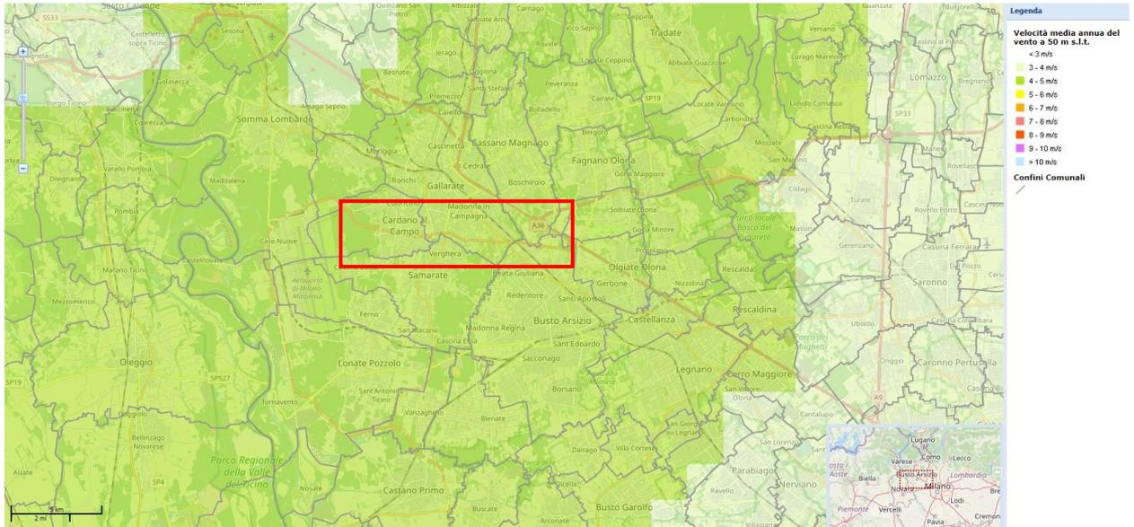
Figura 6.19 Inquadramento dell'area di intervento nella mappa di velocità media annua del vento a 50 m s.l.t.
