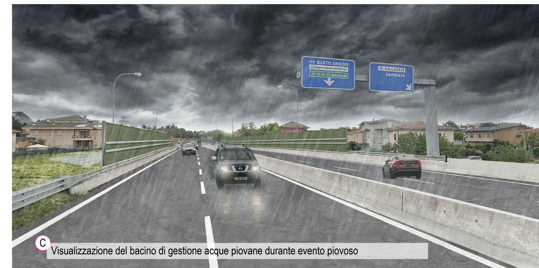
C Intervento di riposizionamento corpi illuminanti, ampliamento stradale, aggiornamento barriere di sicurezza stradale ed antirumore, inserimento di bacini per gestione acque piovane
