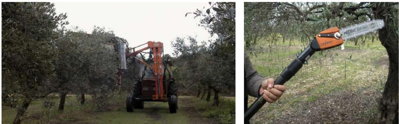
Figure 7-62. A sinistra\_ Esempio di potatrice meccanica frontale a doppia barra (taglio verticale + topping) utilizzabile su tutti le colture arboree intensive e superintensive; A destra\_ Attrezzatura manuale elettrica o a scoppio.
