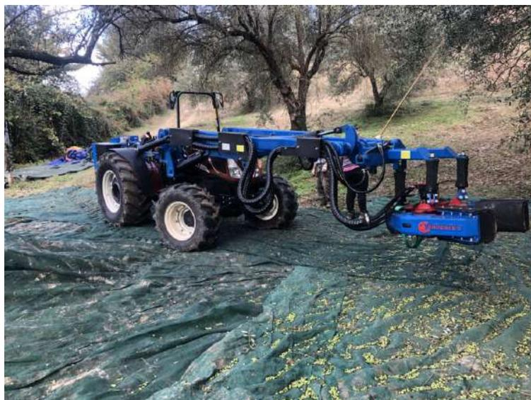
Figure 7-60. Macchina frontale per la raccolta delle olive su impianto intensivo
