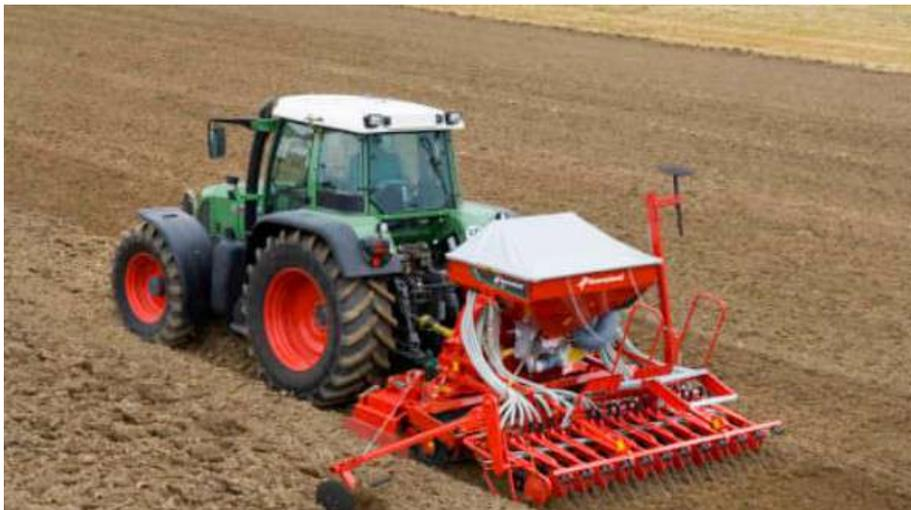
Figure 7-66. Esempio di seminatrice pneumatica per tutte le tipologie di sementi.
