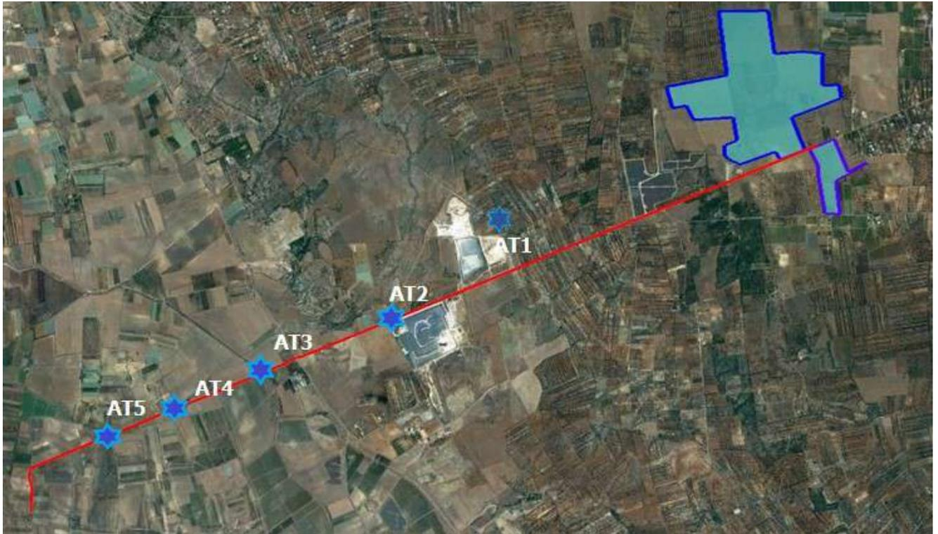
Figura 7-2. Planimetria degli attraversamenti con tecnica "No dig"
