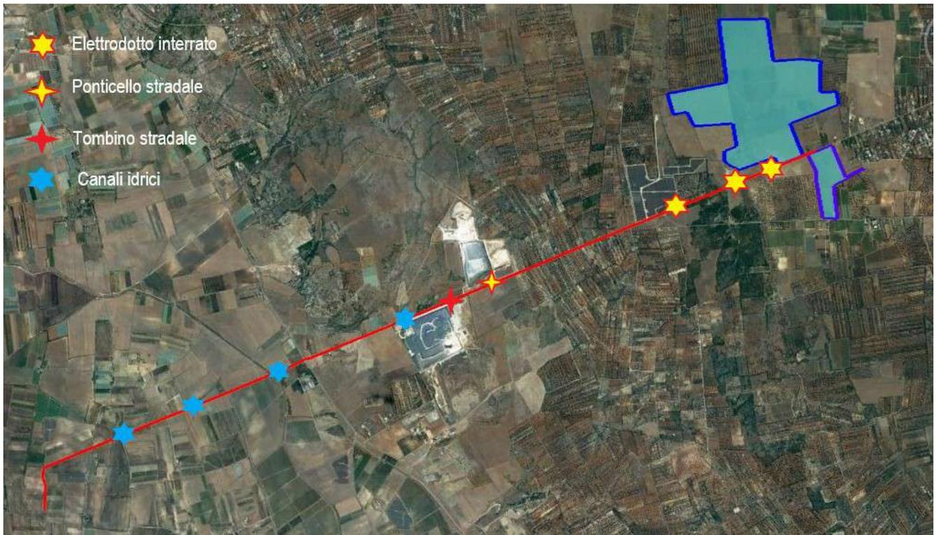
Figure 7-19. Vista d'insieme del campo agrivoltaico, del punto di connessione e del percorso dell'elettrodotto interrato con interferenze.
