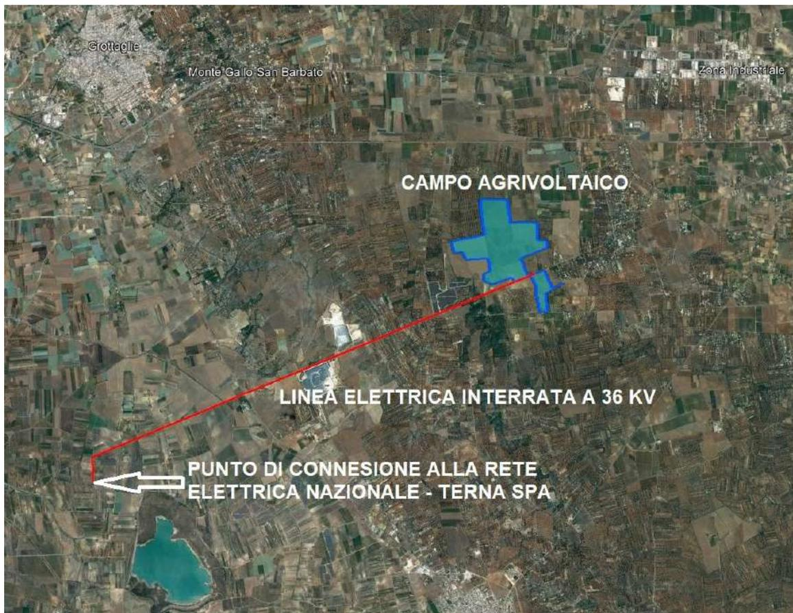
Figure 3-5. Vista d'insieme dell'impianto con collegamento elettrico (in blu)
