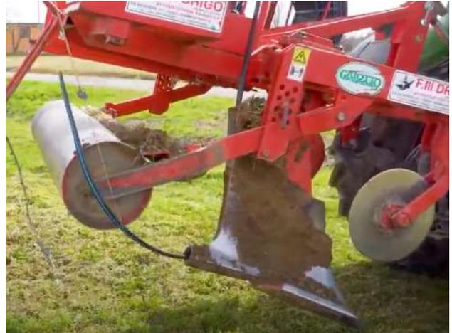
Figure 7-65. Posa ala gocciolante per impianto di sub-irrigazione.
