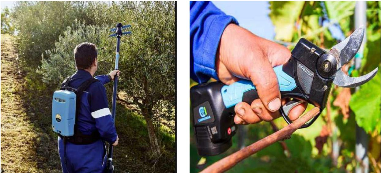
Figure 7-61. Forbici e abbacchiatori elettrici per agevolare i lavori manuali
