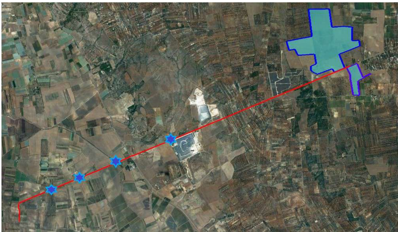
Figure 2-11. Planimetria degli attraversamenti con tecnica "No dig"
