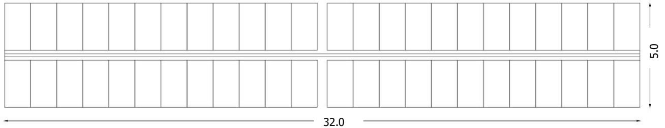
Vista laterale e in pianta di due stringhe fotovoltaiche
