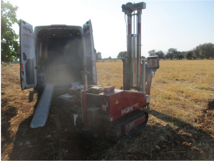
Prova penetrometrica dinamica continua DPSH n.2
