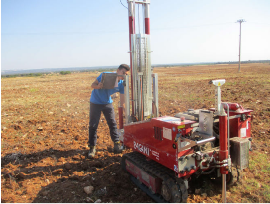
Prova penetrometrica dinamica continua DPSH n.3
