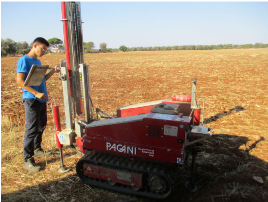
Prova penetrometrica dinamica continua DPSH n.2
