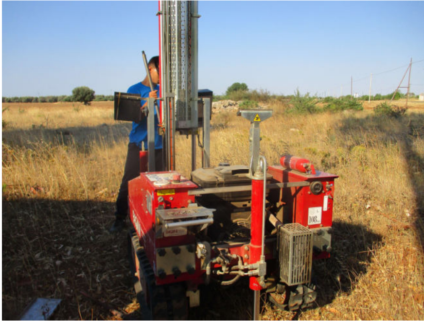
Prova penetrometrica dinamica continua DPSH n.1
