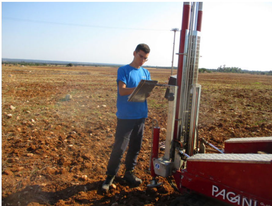
Prova penetrometrica dinamica continua DPSH n.3
