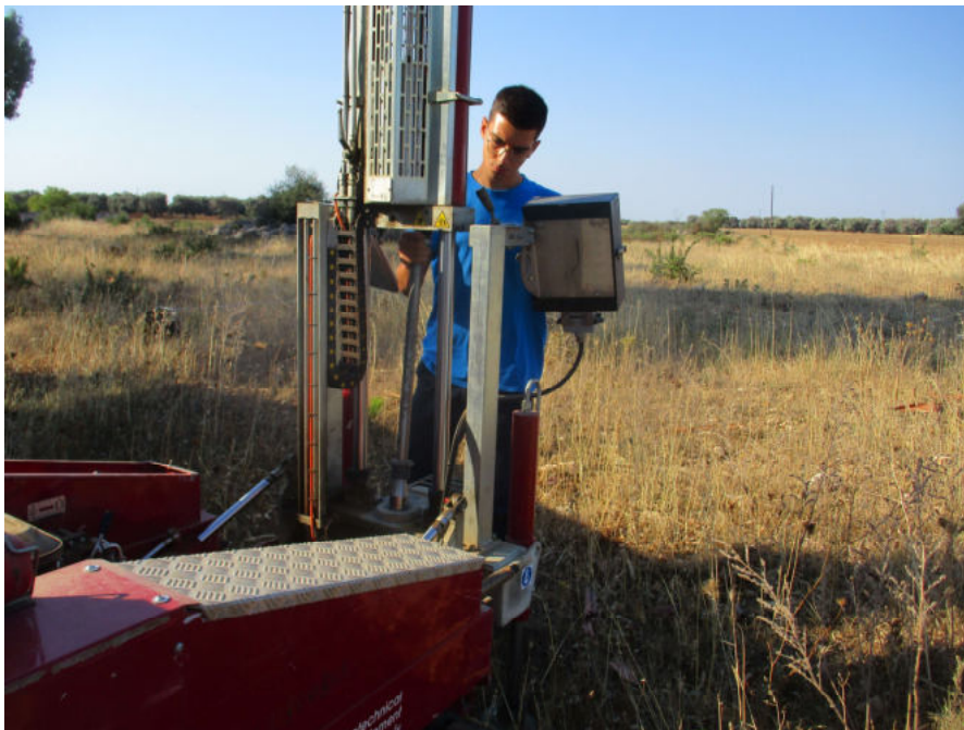
Prova penetrometrica dinamica continua DPSH n.1
