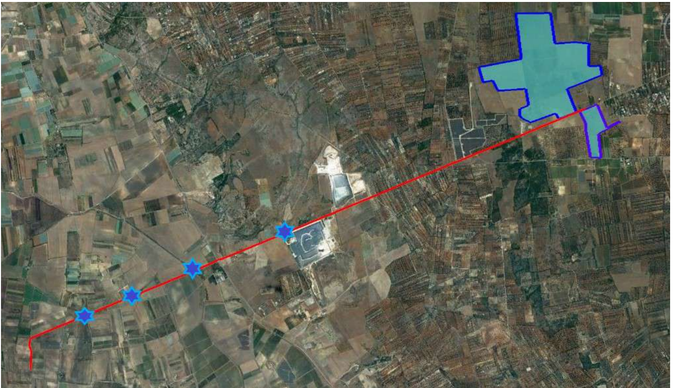
Figure 2-11. Planimetria degli attraversamenti con tecnica "No dig"
