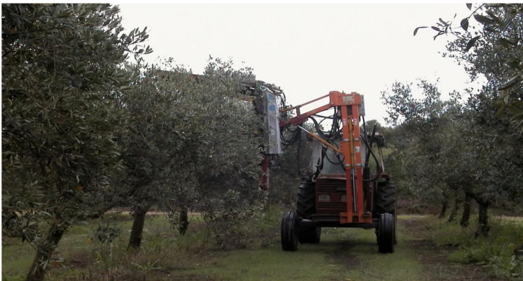
Figure 4-7. A sinistra_ Esempio di potatrice meccanica frontale a doppia barra (taglio verticale + topping) utilizzabile su tutti le colture arboree intensive e superintensive; A destra_ Attrezzatura manuale elettrica o a scoppio.
