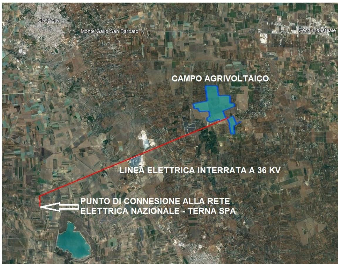
Figure 2-5. Vista d'insieme dell'impianto con collegamento elettrico (in blu)
