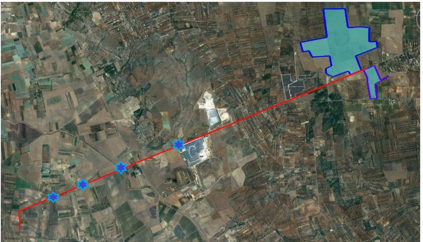
Figure 2-11. Planimetria degli attraversamenti con tecnica "No dig"
