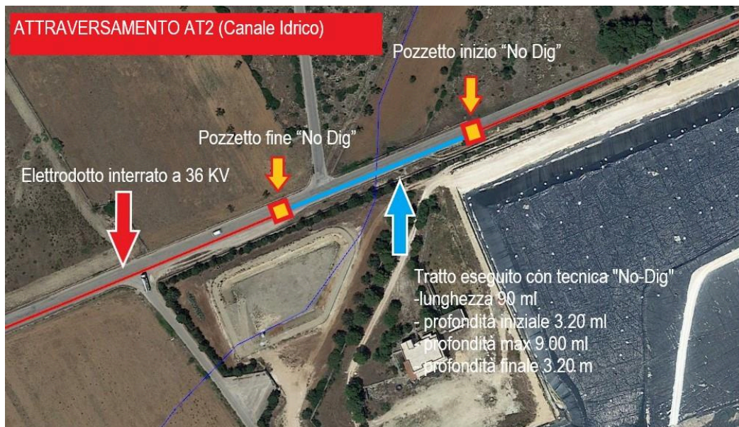
Rappresentazione su ortofoto dell' attraversamento 1 (AT1) con tecnica "No dig"
