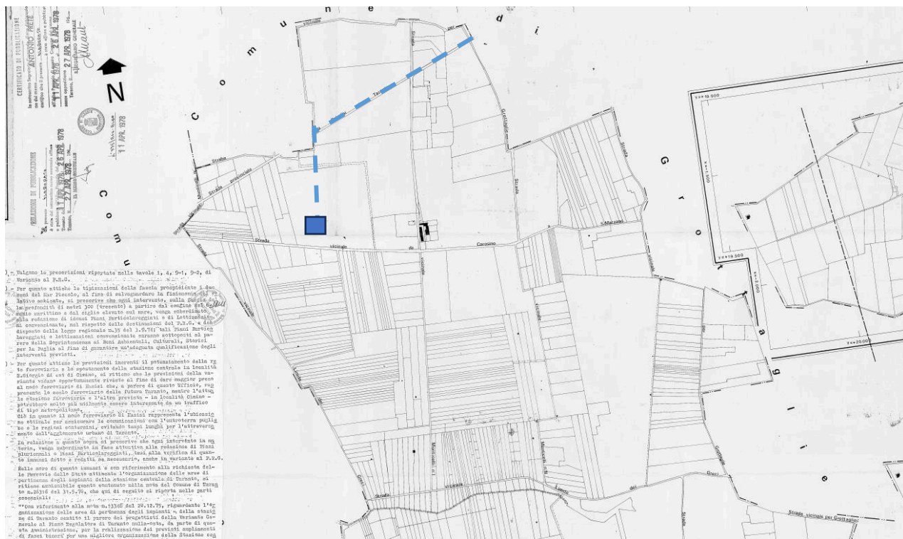
PRG del comune di Taranto- percorso elettrodotto interrato (linea blu tratteggiata) e punto di connessione alla RTN (rettangolo blu)
