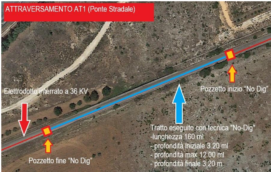
Rappresentazione su ortofoto dell' attraversamento 1 (AT1) con tecnica "No dig"
