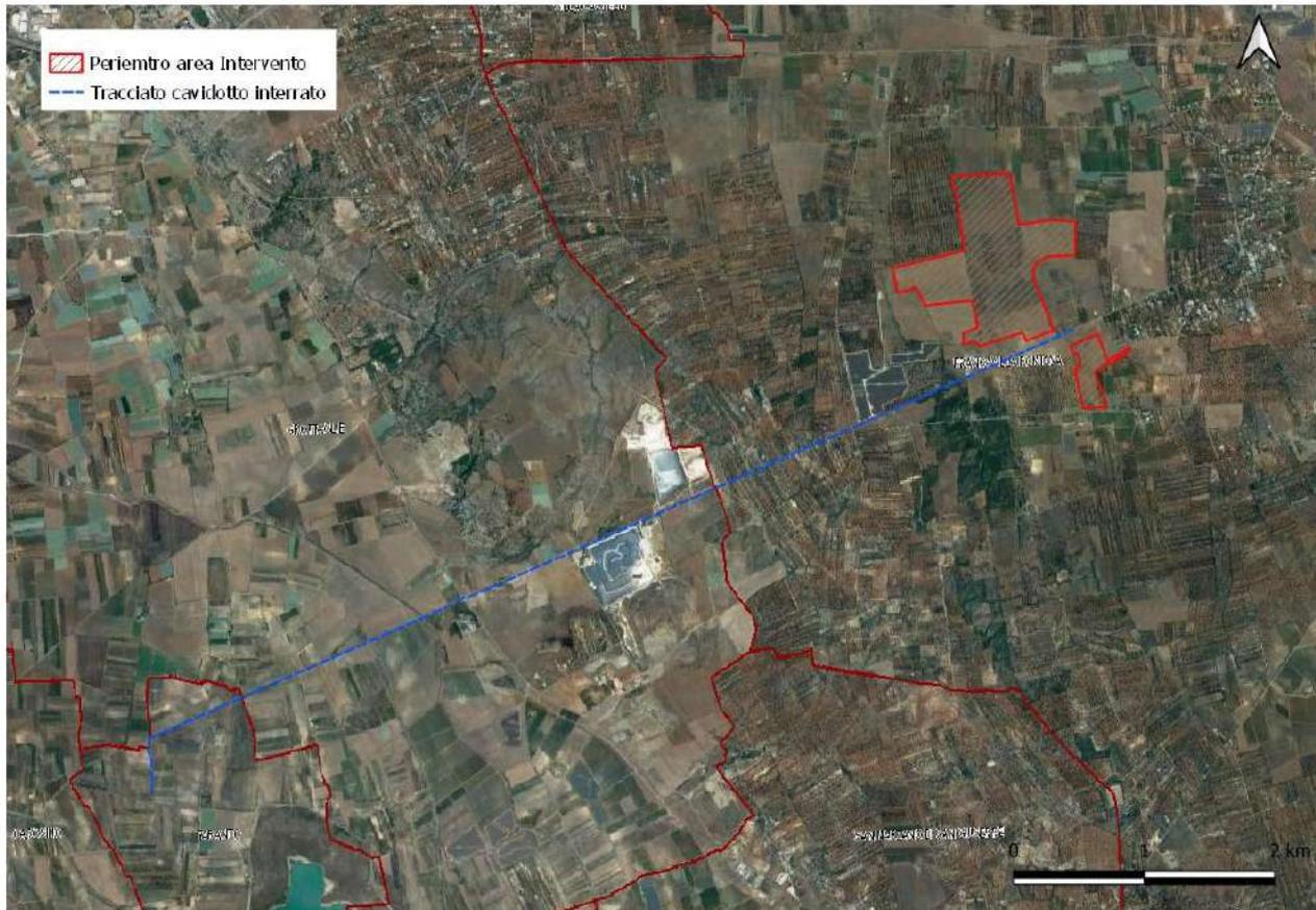
Figure 2-1 Sovrapposizione Area impianto e tracciato cavidotto interrato su ortofoto
