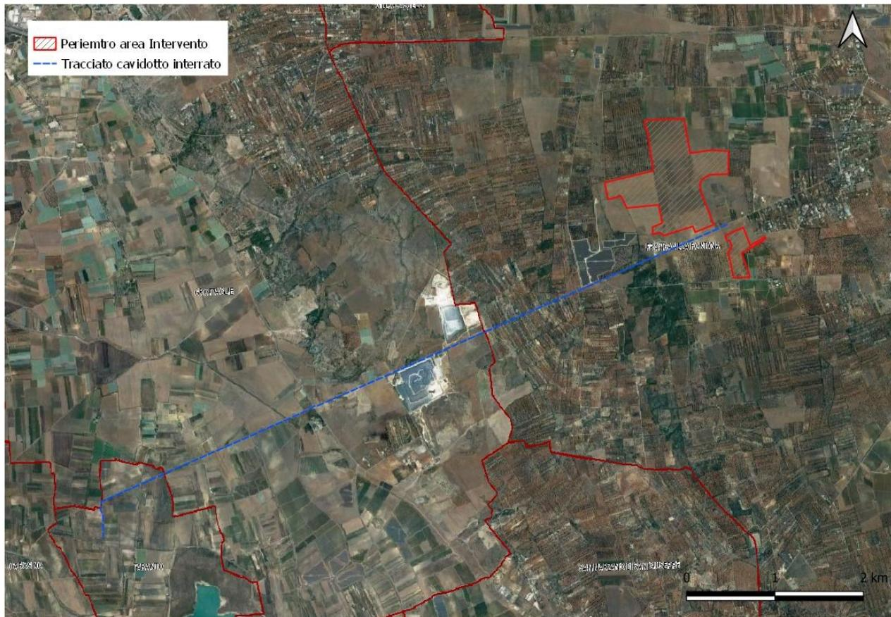
*Figura 2-1 Sovrapposizione Area impianto e tracciato cavidotto interrato su ortofoto*
