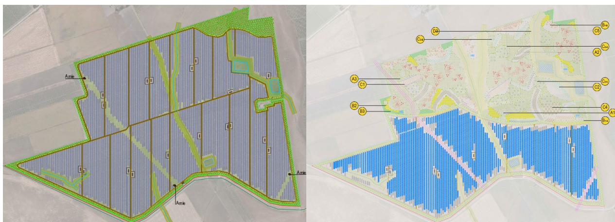
Figura 1 - IMP_B_01: Interventi di mitigazione prima (sinistra) [rif. CLBSIAT20-00] e interventi di mitigazione dopo la revisione (destra) [rif. CLBSIAT20-01]
