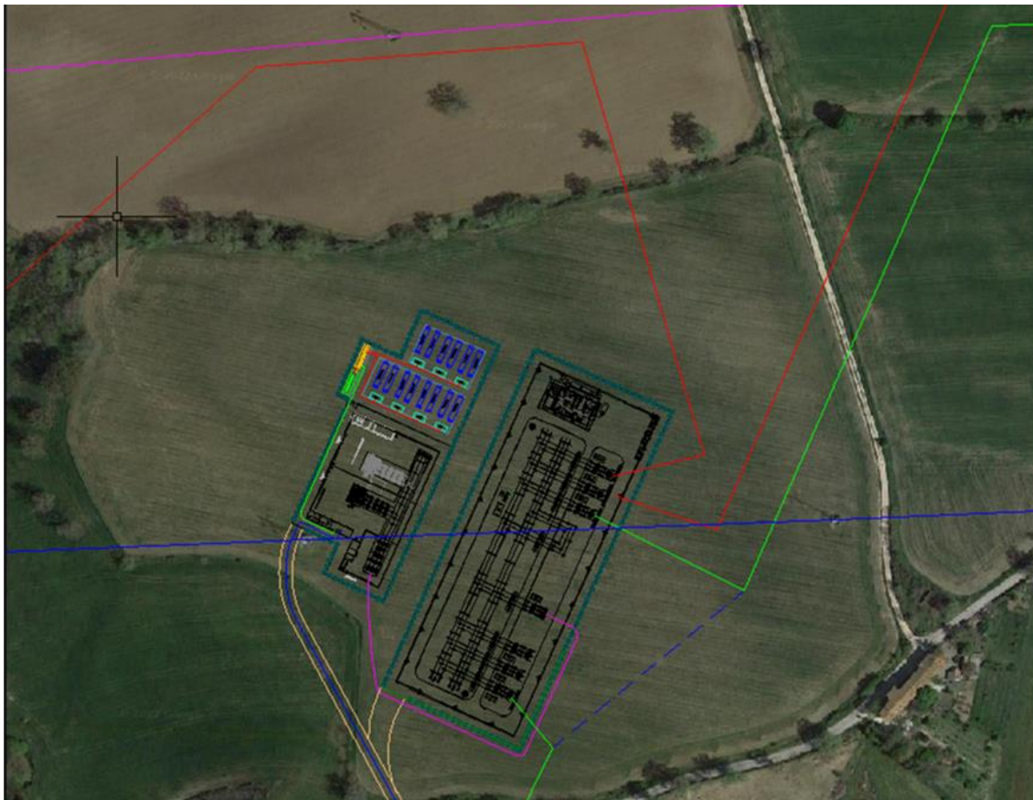
Figura 7 – Stralcio su ortofoto della posizione del sistema di accumulo (BESS), della Stazione Utente, del cavidotto in AT e della Stazione di Smistamento 132 kV
