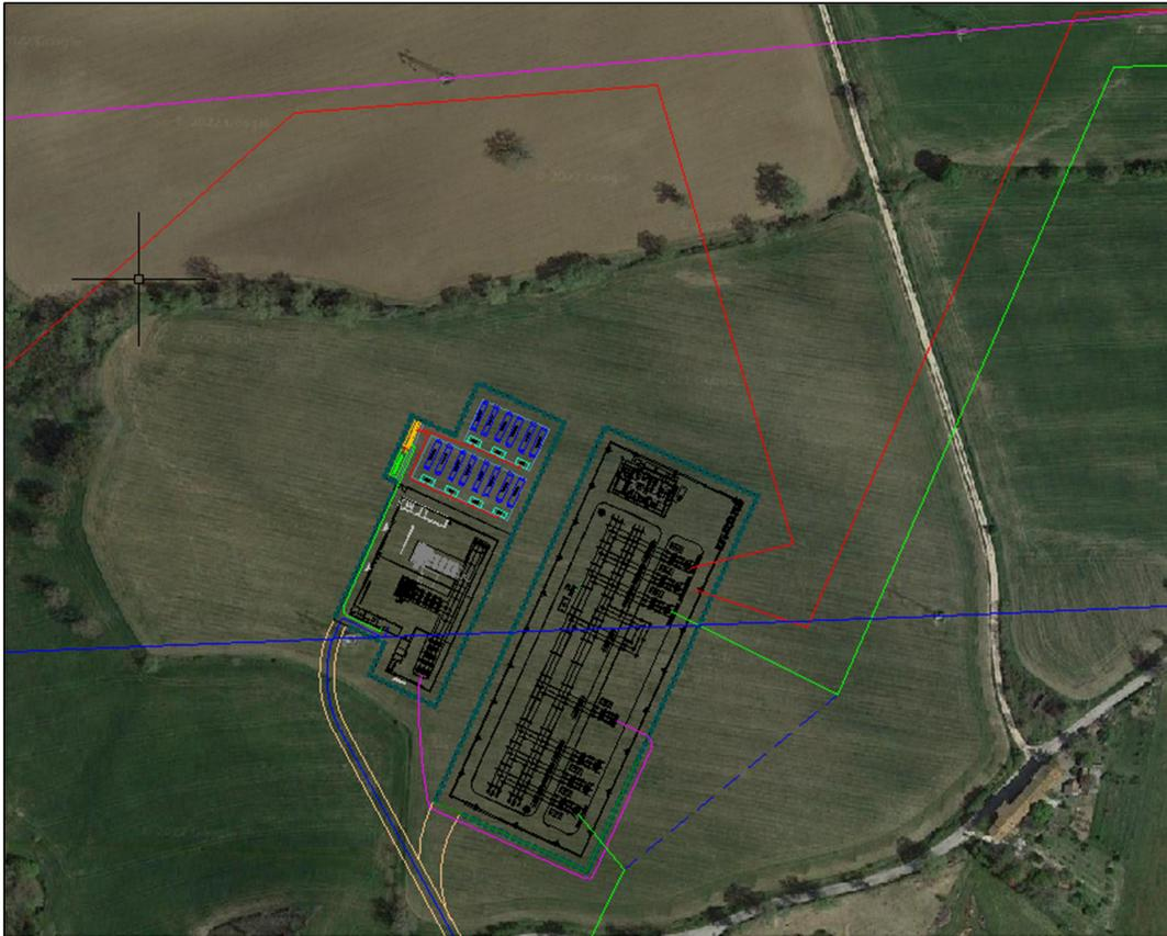
*Figura 1 – Stralcio su ortofoto della posizione della stazione utente, del cavidotto in AT, i raccordi aerei e la Stazione della RTN*
