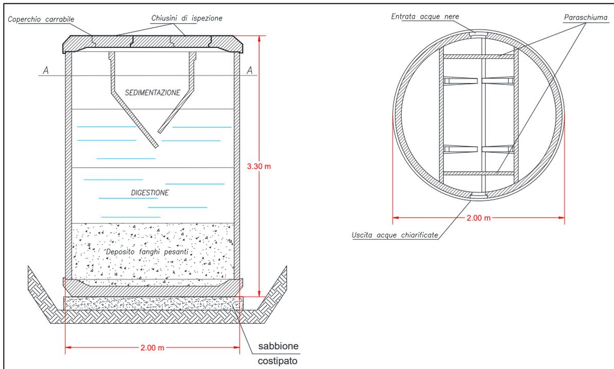
Figura 4 – Sezione e pianta della vasca Imh
