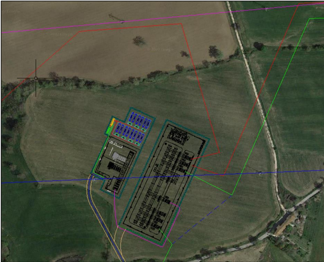
Figura 17: Inquadramento su ortofoto: stazione utente collegata con la stazione elettrica di smistamento a 132 kV da realizzare in località di "Arcofiato"
